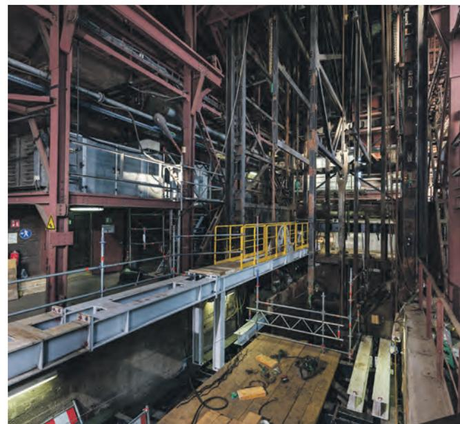
Verschubbahn zum Ausfahren der Förderkörbe im Schachtkeller
