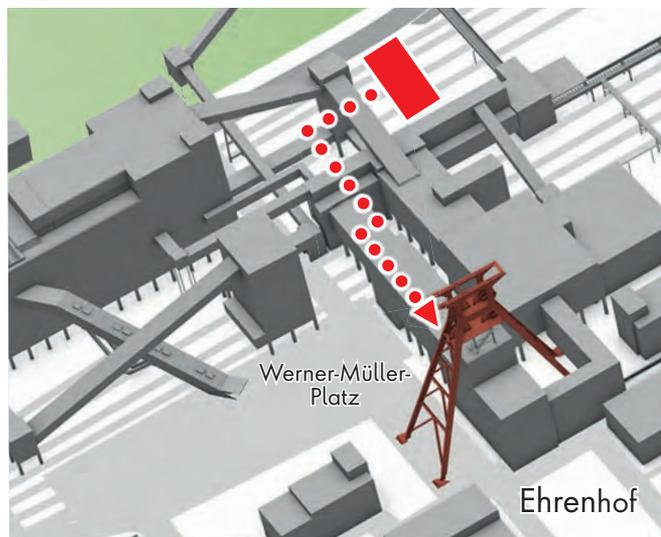
Von den Anlieferungshallen wird der Beton über Rohrleitungen zu den Schächten gepumpt.
